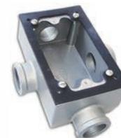
**AFS** Caja rectangular con tapa atornillada para interruptores, tomas y pulsadores con disposición de vías E, C, L, T y X con roscas de 5/8" hasta 1" BSC y 1/2"-3/4" NPT.
